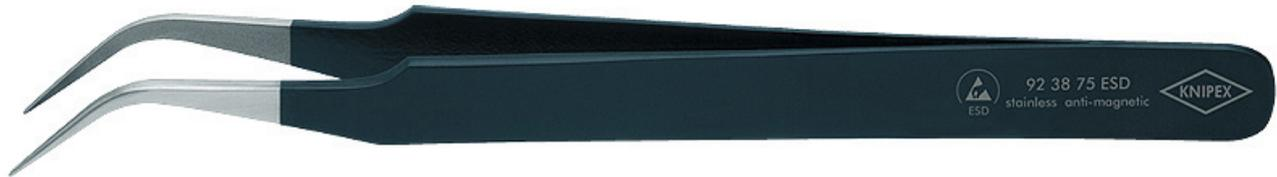
ESD Chrom-/ Nickel-Stahl: rostfrei, antimagnetisch (18/10), sehr gängige Elektronik-Qualität. ESD-Beschichtung: blendfrei schwarz, mit einem Oberflächenwiderstand von ca.  $10^5$  Ohm. Spitzen blendfrei gebürstet. Greifflächen mattiert für optimalen Halt. sichelförmige Spitzen. Greifflächen glatt. - Ausführung: rostfrei, antimagnetisch, elektrisch ableitend - ESD: Ja
