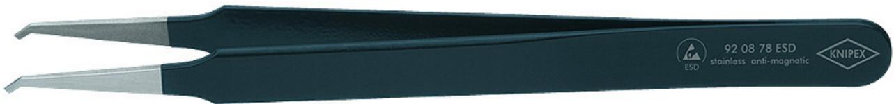
ESD Chrom-/ Nickel-Stahl: rostfrei, antimagnetisch (18/10), sehr gängige Elektronik-Qualität. ESD-Beschichtung: blendfrei schwarz, mit einem Oberflächenwiderstand von ca.  $10^5$  Ohm. Spitzen blendfrei gebürstet. Greifflächen mattiert für optimalen Halt. für SMD-Technik\*. gewinkelte Spitzen. Greifflächen glatt. - Ausführung: rostfrei, antimagnetisch, elektrisch ableitend - ESD: Ja
