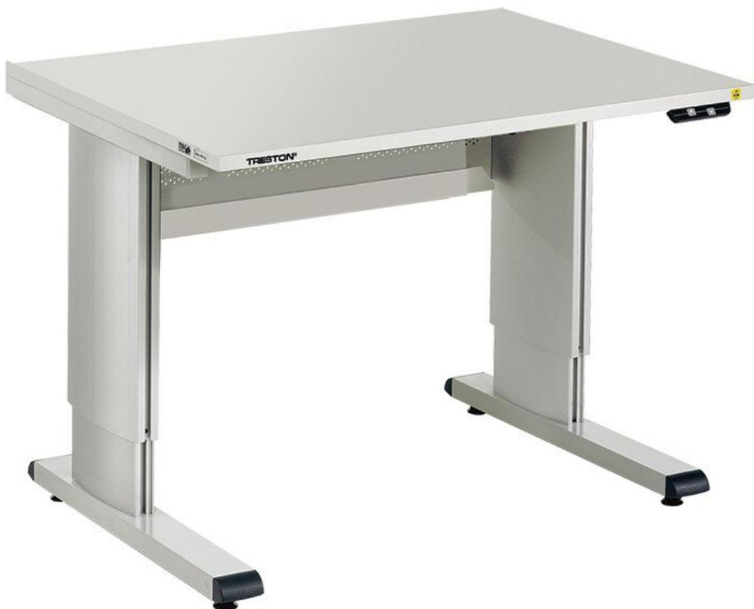
Die Treston Arbeitstische der Serie WB eignen sich besonders für den Einsatz in der Elektronikindustrie. Die Höhe der Tischplatte kann stufenlos mittels Elektromotor eingestellt werden. Die Einstellgeschwindigkeit des Motors beträgt 19 Sekunden von Minimum bis Maximum.
