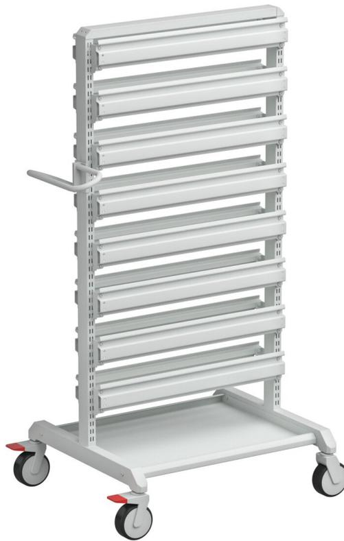
Der ESD-Kästenwagen von Treson ist einseitig mit beidseitig 8 Stahlschienen ausgerüstet. ESD-Sichtlagerkästen, welche separat zu bestellen sind, werden an den Kästenschiene befestigt. Der Wagen verfügt über 4 ESD-Lenkrollen mit einem Durchmesser von 100 mm, zwei davon mit Bremse. Eine untere Stahlablage ist serienmäßig enthalten. Durch den höhenverstellbaren, ergonomischen Griff, lässt sich der Wagen leicht manövrieren.
