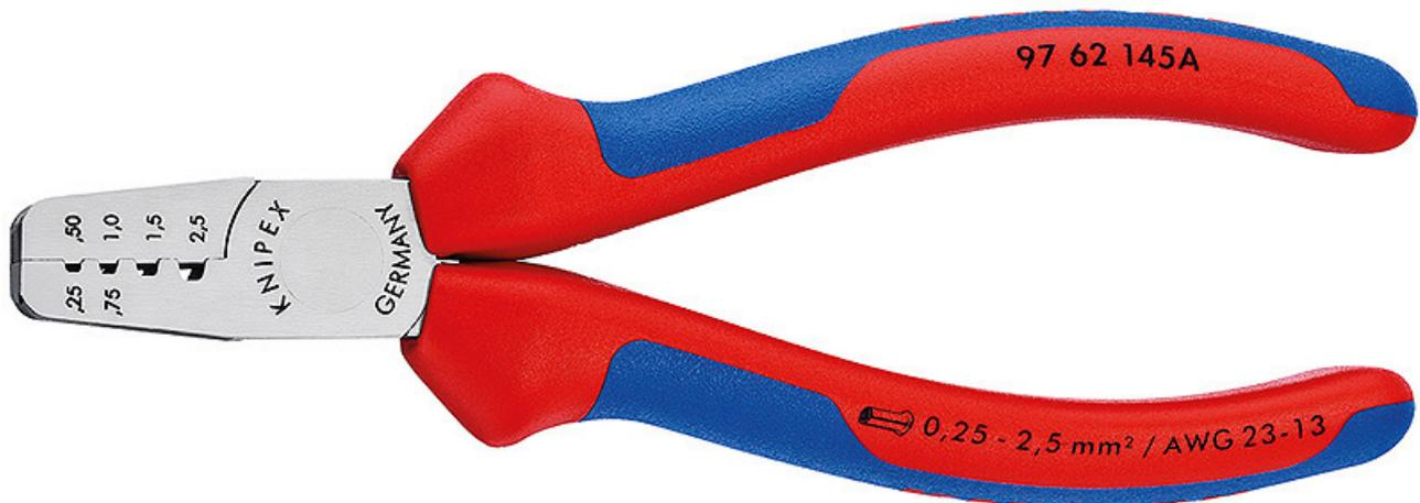
Crimpzange für Aderendhülsen Zum Verpressen von Aderendhülsen DIN 46228 Teil 1 + 4 im Bereich von 0,25 bis 2,5 mm<sup>2</sup>. Verpressung in gekennzeichneten Trapezprofilen für die sichere Verbindung von Hülse und Leiter. - Anwendung: Aderendhülsen - Kapazität Quadratmillimeter: 0,25 — 2,5mm<sup>2</sup> - Anzahl der Nester: 4 - AWG: 23 — 13
