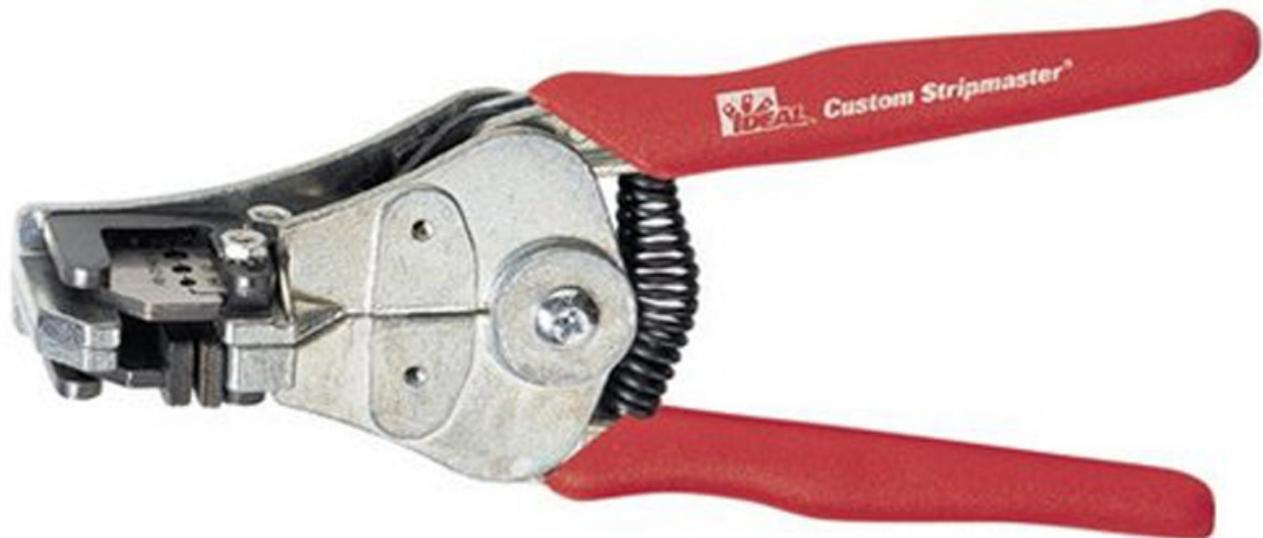
Der Stripmaster besitzt eine an den Isolationsdurchmesser angepasste Ansenkung und eine an den Leiterdurchmesser angepasste innere Schneidebohrung. Die angesenkte Bohrung zentriert die Leitung und verhindert, dass das Messer den Innenleiter beschädigt
