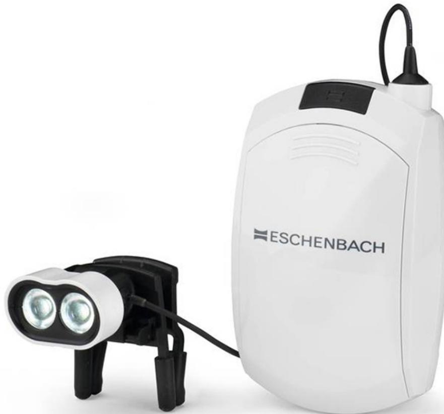
Das headlight Licht von Eschenbach ist in die jeweils gewünschte Position vertikal schwenkbar. Der Strahler ermöglicht ein schatten- und flimmerfreies Arbeiten bei gleichzeitig geringem Energieverbrauch, da die Lampe für den Akkugebrauch optimiert ist. Das Batteriegehäuse kann komfortabel am Gürtel oder in der Hemdtasche getragen werden.
