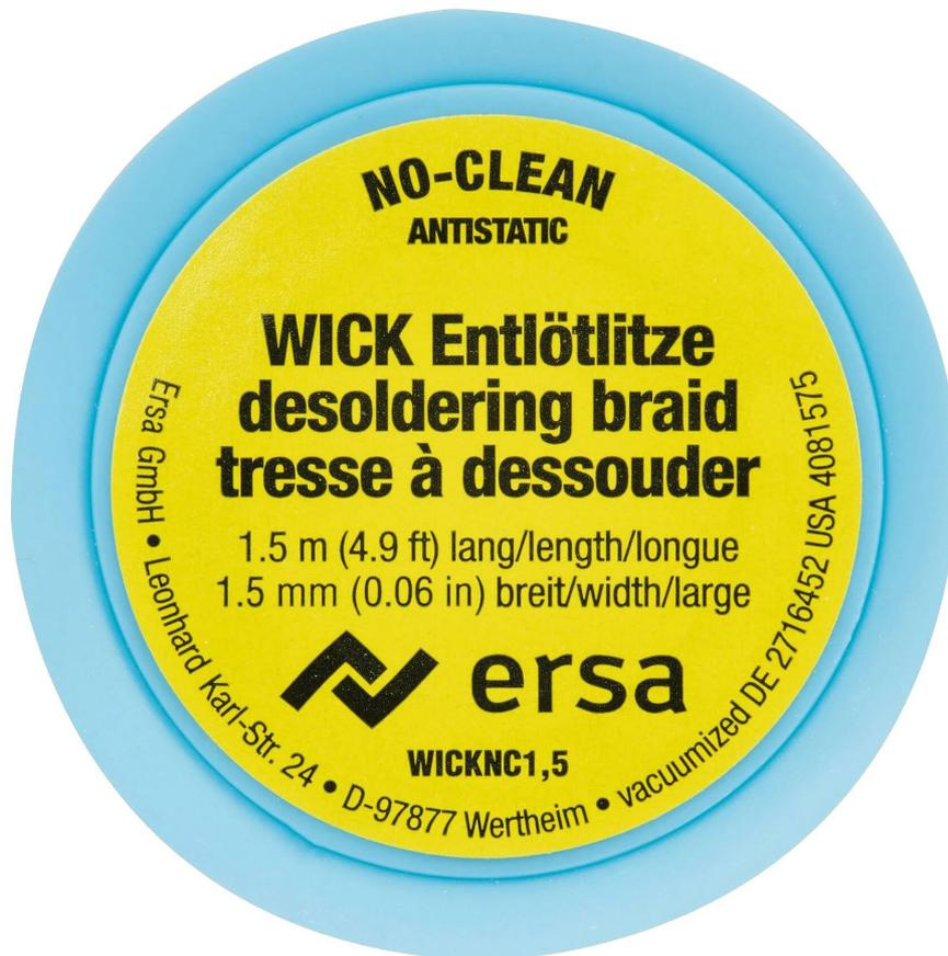
Ersa Entlötlitzen sind mit halogenfreiem No-Clean-Flussmittel versehen und eignen sich optimal zum schonenden Entfernen von überschüssigem oder altem Lötzinn, insbesondere bei SMD-bestückten Leiterplatten. Das feine Kupfergeflecht mit hoher Kapillarkraft und einer Breite von 1,5 mm und gewährleistet beste Entlötergebnisse. In manchen Fällen kann der zusätzliche Einsatz einer Flussmittelcreme hilfreich sein.
