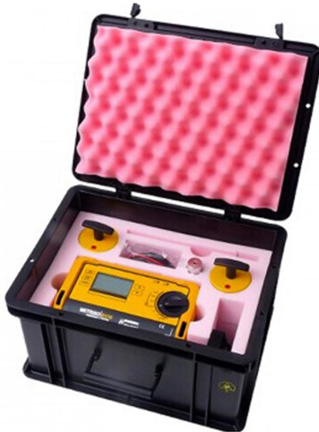
Das Metriso Mess Kit von Warmbier ist ein digitales Hochohmmeter, das zur Messung von Punkt-zu-Punkt-Widerständen sowie zur Überprüfung von Ableitwiderständen von Personen, Schuhen, Matten und Bodensystemen in einem ESD-Bereich eingesetzt wird.
