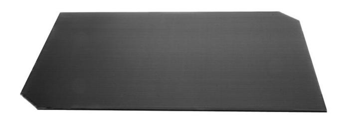
Die Safeguard ESD Zwischenlagen in schwarz für Euro-Behälter mit den Abmessungen von  $400 \times 300$  mm bestehen aus einem volumenleitfähigen Hohlkammermaterial (Polypropylen). Dieses zeichnet sich vor allem durch ein geringes Eigengewicht und eine hohe Abriebfestigkeit aus. Die Abmessungen der Zwischenlagen sind L x B x H = 353 x 253 x 3 mm. Jede Zwischenlage hat zwei abgeschrägte Ecken, die das Herausnehmen erleichtern.
