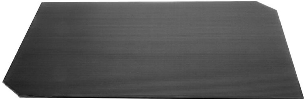
Die Safeguard ESD Zwischenlagen in schwarz für Euro-Behälter mit den Abmessungen von 400 x 300 mm bestehen aus einem volumenleitfähigen Hohlkammermaterial (Polypropylen). Dieses zeichnet sich vor allem durch ein geringes Eigengewicht und eine hohe Abriebfestigkeit aus. Die Abmessungen der Zwischenlagen sind L x B x H = 353 x 253 x 3 mm. Jede Zwischenlage hat zwei abgeschrägte Ecken, die das Herausnehmen erleichtern.
