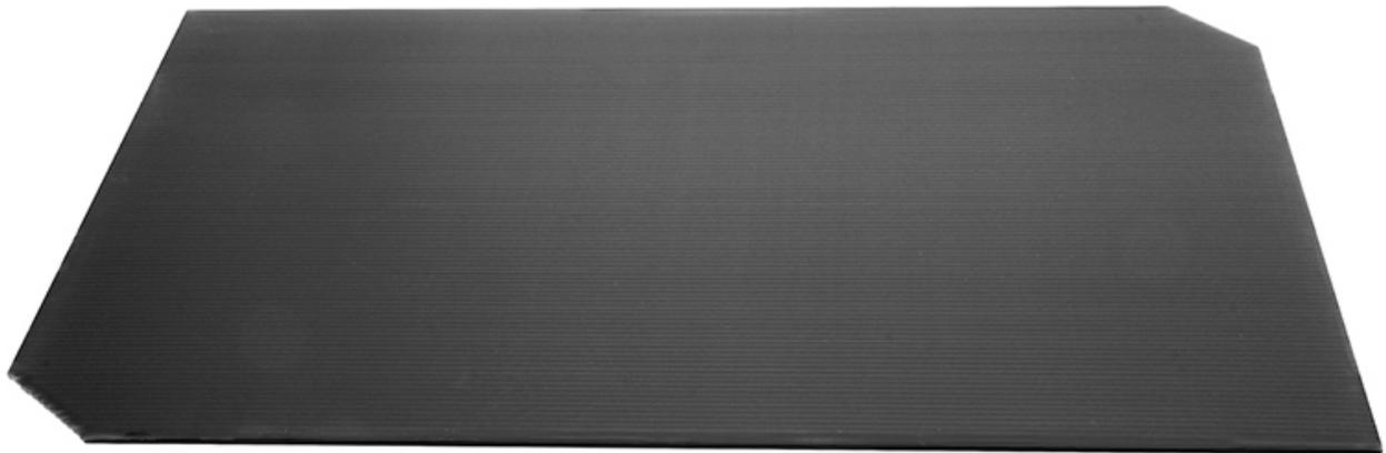
Die Safeguard ESD Zwischenlagen in schwarz für Euro-Behälter mit den Abmessungen von 600 x 800 mm bestehen aus einem volumenleitfähigen Hohlkammermaterial (Polypropylen). Dieses zeichnet sich vor allem durch ein geringes Eigengewicht und eine hohe Abriebfestigkeit aus. Die Abmessungen der Zwischenlagen sind L x B x H = 553 x 353 x 3 mm. Jede Zwischenlage hat zwei abgeschrägte Ecken, die das Herausnehmen erleichtern.
