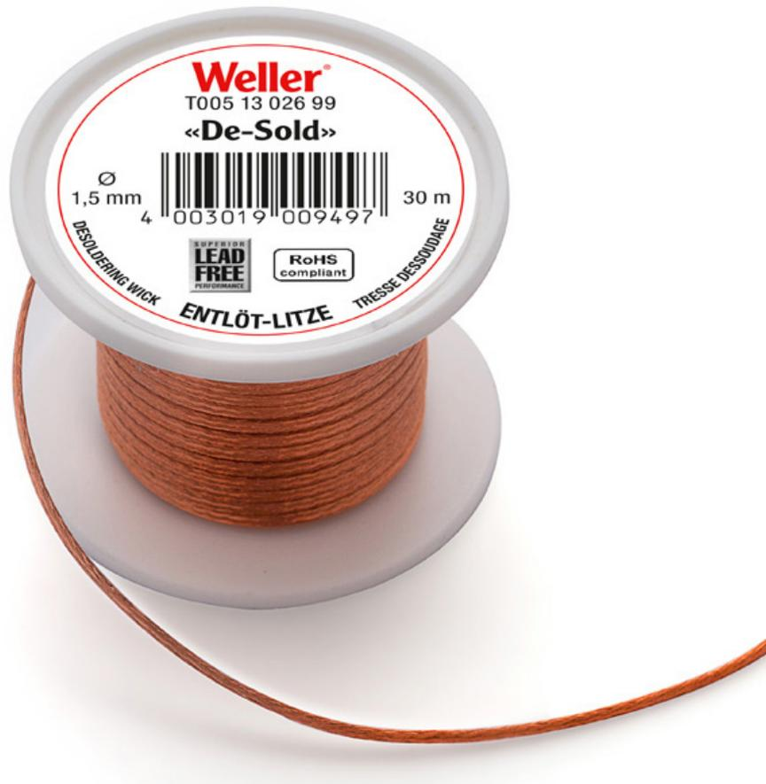
Entlötlitzen bestehen aus flussmittelgetränktem Kupfergeflecht. Durch das Flussmittel kann das Kupfer problemlos benetzt werden. Die Kapillarkraft in dem feinen Geflecht saugt das flüssige Lötzinn auf.
