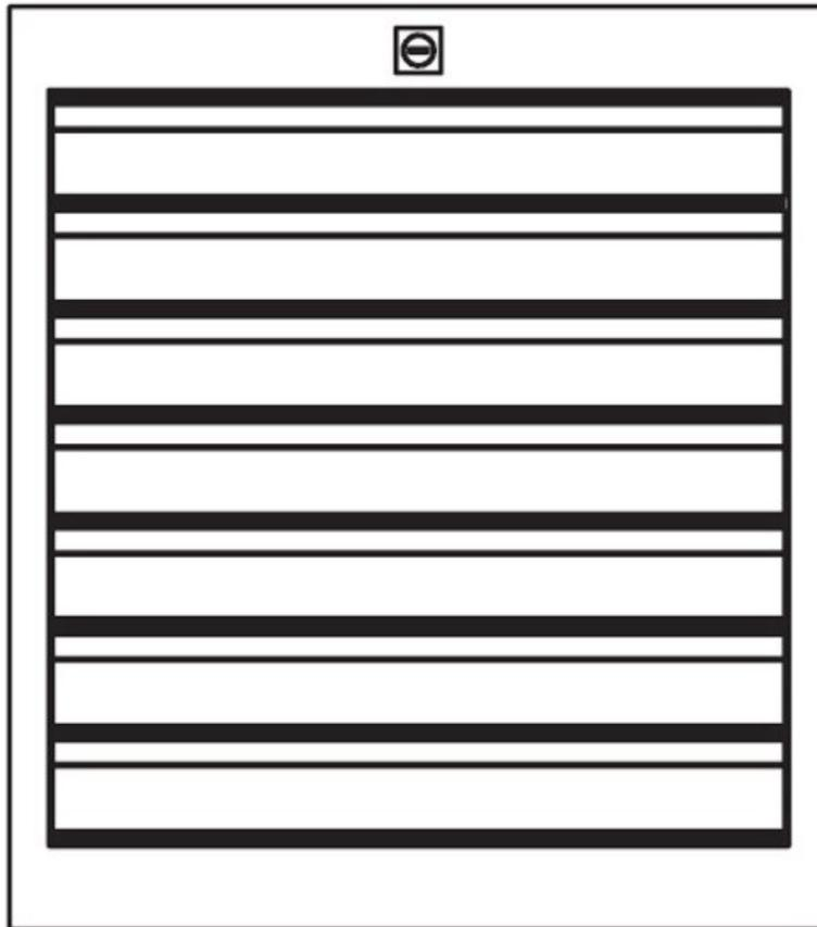
Der Schubkastenblock F1 zeichnet sich durch seine kompakten Maße aus: Mit einer Höhe von 475 mm, einer Tiefe von 540 mm und einer Breite von 606 mm ist er platzsparend und dennoch geräumig. Er bietet sieben Schubladen mit jeweils einer Höheneinheit (1 HE), was eine effiziente Nutzung des Stauraums ermöglicht. Ideal für die geordnete Aufbewahrung von verschiedenen Gegenständen in Büro- oder Wohnbereichen.
