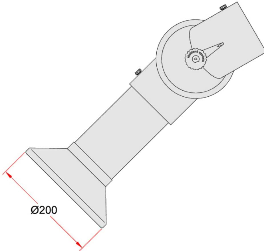
Metallhaube empfohlen für die Erfassung von Warmgas, Rauch und leichten Staubmengen
