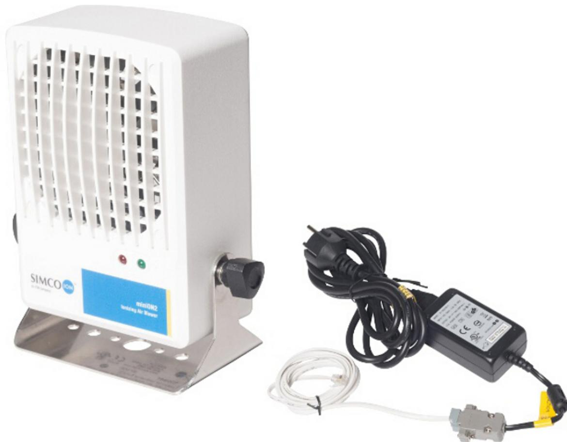
Mit einem Ionisierungsgeräte von SIMCO lassen sich elektrostatische Aufladungen an Arbeitsplätzen und im ESD-Servicebereich neutralisieren. Das integrierte Gebläse ist stufenlos einstellbar. Bei dem Ionisiergerät basiert die Ionisation auf Hochfrequenz-Wechselspannung (HF-AC).
