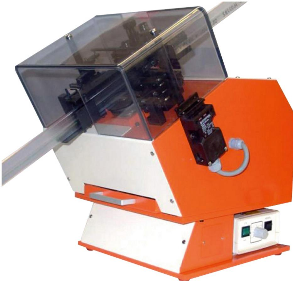
Schneide- / Präge- + Biegegerät für radiale Bauteile
