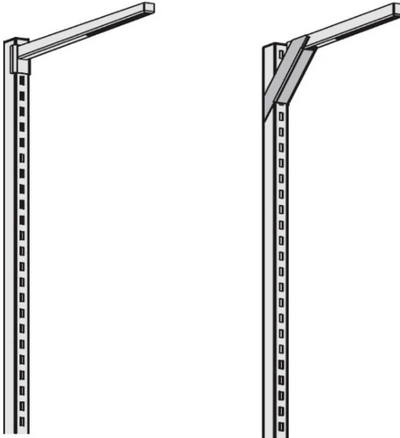
Der Ausleger für Sintro ermöglicht eine Aufnahme von Laufschienen, Langfeldleuten oder ähnlichem.
