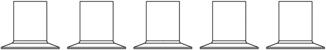
Vakuumsauger, D = 8,0 mm
