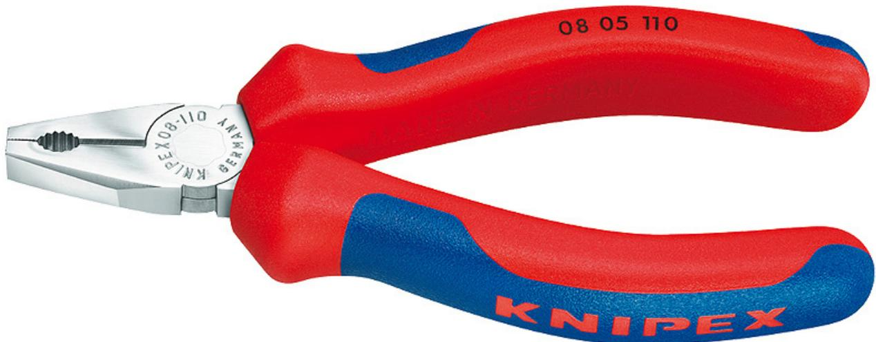
Kompakte Kombizange für Handwerk und Hobby. Mit Greifzonen für Flach- und Rundmaterial für vielseitigen Einsatz. Mit Schneiden für weichen und harten Draht. Schneiden zusätzlich induktiv gehärtet, Schneidenhärte ca. 60 HRC. - Schneidwerte mittelharter Draht (Durchmesser): Ø 2,5mm - Schneidwerte harter Draht (Durchmesser): Ø 1,6mm - Schneidwert Cu-Kabel, mehrdrähtig: Ø 9,0mm - Schneidwert Cu-Kabel, mehrdrähtig: 10,0mm<sup>2</sup>
