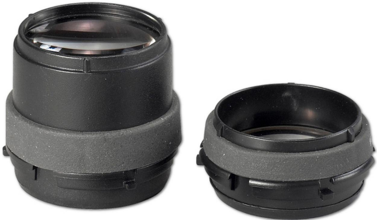
Das hochwertige Vision Engineering Objektiv MCO-008 mit 8-facher Vergrößerung eignet sich für die Verwendung mit dem okularlosen Stereomikroskop Mantis Compact. Es lässt sich einfach und schnell durch Drehen und Verriegeln einsetzen sowie entnehmen. Der Arbeitsabstand beträgt hierbei 58,5 mm, der Bildausschnitt 14,3 mm.
