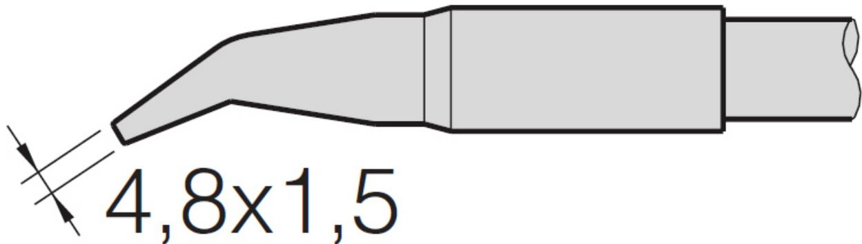
Die Löspitzenserie C130 sind für das Handstück AP130 geeignet und verfügen über gebogene Spitzen, die perfekt an die die Position des Zinndrahts angepasst sind. Die Spitzen können mit Hilfe der Verdrehsicherung am Handstück ausgerichtet werden.
