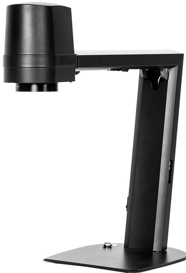
Das Digitalmikroskop ZIP von Tagarno ist ein einfaches und kleines Inspektionssystem, das für Aufgaben mit geringerer Vergrößerung geeignet ist. Zudem überzeugt es durch seine Benutzerfreundlichkeit und das geringe Gewicht. Es besitzt einen 30-fachen optischen Zoom, 60 FPS Bildraten, 280 mm Arbeitstiefe, Full HD1080p-Bildqualität sowie einer 53-fachen Vergrößerung. Das Set beinhaltet in diesem Set das Mikroskop ZIP, die XKEY Steuerungsbox und ein Objektiv mit 4fach Zoom (4+).
