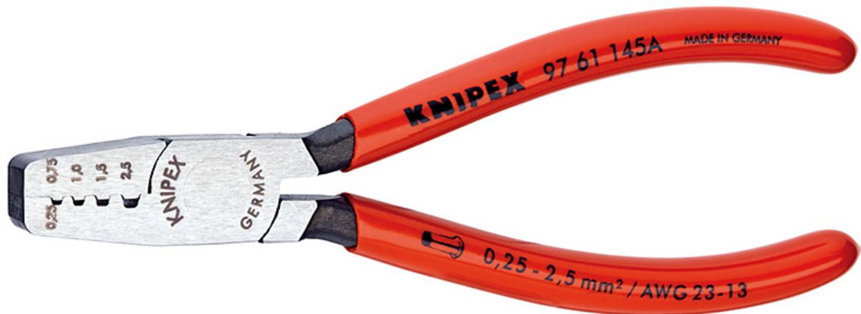
Crimpzange für Aderendhülsen Zum Verpressen von Aderendhülsen DIN 46228 Teil 1 + 4 im Bereich von 0,25 bis 2,5 mm<sup>2</sup>. Verpressung in gekennzeichneten Trapezprofilen für die sichere Verbindung von Hülse und Leiter. - Anwendung: Aderendhülsen - Kapazität Quadratmillimeter: 0,25 — 2,5mm<sup>2</sup> - Anzahl der Nester: 4 - AWG: 23 — 13
