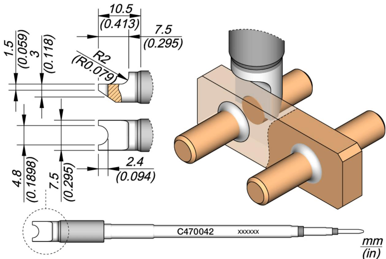
Aufgrund ihrer Größe sind diese Sonderlötspitzen für intensive Lötarbeiten geeignet und eignen sich sowohl für SMD als auch für Anwendungen mit hohem Leistungsbedarf. JBC Long Life Tips bieten eine sofortige Erwärmung, eine hervorragende Wärmeübertragung und eine lange Lebensdauer. Dank des JBC Most Efficient Soldering System und der Sleep & Hibernation Funktionen halten sie 5 mal länger als vergleichbare Modelle.
