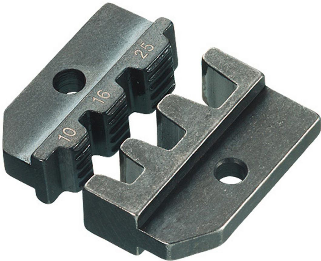
Anwendung: isolierte + unisolierte Aderendhülsen 10 / 16 / 25 mm<sup>2</sup>. - Nennmaß: 10 / 16 / 25 mm<sup>2</sup> - Anwendung: isolierte + unisolierte Aderendhülsen - Kapazität Quadratmillimeter: 10 / 16 / 25mm<sup>2</sup> - Anzahl der Nester: 3 - AWG: 7 / 5 / 3
