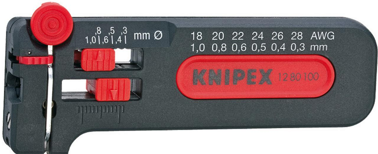
Präzises Abisolieren durch stufenweise Einstellung des Werkzeugs auf den Leiterdurchmesser. Mit Drahtschneider. Mit Längenanschlag: einstellbar von 4,0 bis 15,0 mm. Mit Sperrklinke. für dünne Cu-Leiter Ø 0,3 bis 1,0 mm. - Abisolierwerte (Durchmesser): Ø 0,3 – 1mm - AWG: 28 – 18
