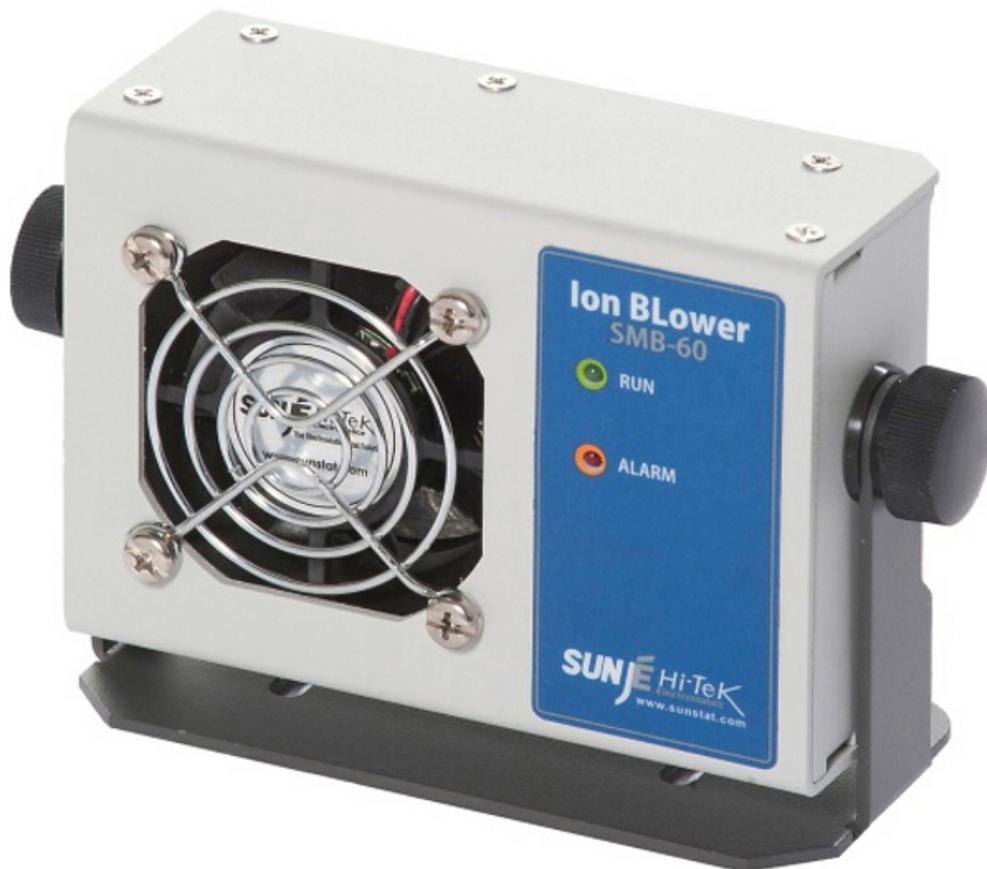
Das mobile, kleine Ionisierungsgerät SMB60 von SIMCO neutralisiert elektrostatische Aufladungen an Arbeitsplätzen und im ESD-Servicebereich. Das integrierte Gebläse ist stufenlos einstellbar. Bei dem Ionisiergerät basiert die Ionisation auf Hochfrequenz-Wechselspannung (HF-AC).
