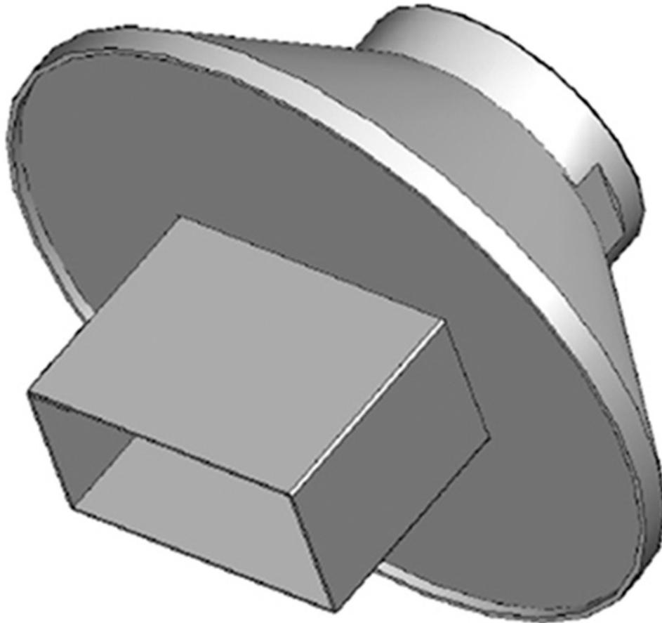
Für die Systeme MRS-1000 / HCT-1000 stehen verschiedene Heißluftdüsen zur Verfügung. Durch diese Auswahl an Düsen können Bauelemente unterschiedlichster Größen, z. B. BGAs, QFPs, LGAs, PLCCs und SOICs einfach entfernt und ersetzt werden. Heißluftdüsen Info: Die Innenabmessungen der Heißluftdüsen (Länge/Breite) sind 2 mm größer als die angegebenen Bauteilgrößen in mm. Größere Düsen ermöglichen eine gleichmäßige Bauteilerwärmung.
