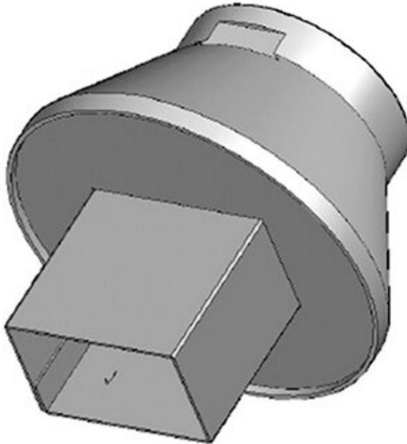
Für die Systeme MRS-1000 / HCT-1000 stehen verschiedene Heißluftdüsen zur Verfügung. Durch diese Auswahl an Düsen können Bauelemente unterschiedlichster Größen, z. B. BGAs, QFPs, LGAs, PLCCs und SOICs einfach entfernt und ersetzt werden. Heißluftdüsen Info: Die Innenabmessungen der Heißluftdüsen (Länge/Breite) sind 2 mm größer als die angegebenen Bauteilgrößen in mm. Größere Düsen ermöglichen eine gleichmäßige Bauteilerwärmung.
