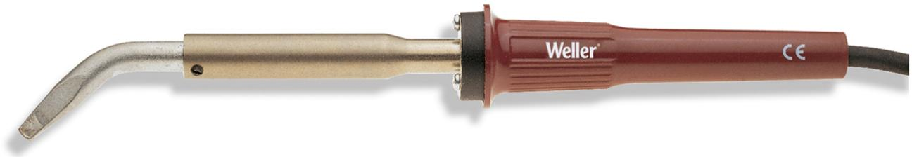
Für Profis und anspruchsvolle Hobby-Elektroniker sind die Original Weller "Longlife"-Spitzen ideal ausgestattet. Robuste Heizkörper aus Spezialstahl mit Glimmer-Isolation, in Keramik eingebettet und erstklassiges Material machen die SPI-Serie von Weller in Funktion und Standzeit überlegen. SPI-LötKolben ohne Temperatur-Kontroll-System sind Werkzeuge für professionelle Lötarbeiten.
