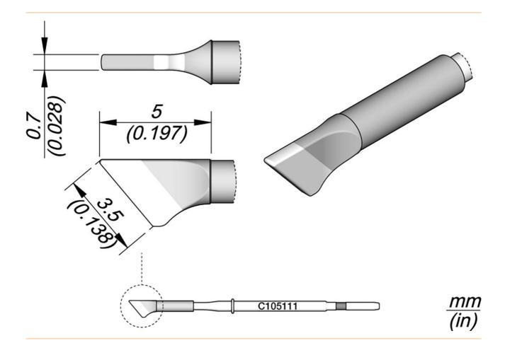
Die Lötspitzen der Serie C105 sind die kleinsten Spitzen der JBC-Serien und eignen sich hervorragend zum Löten und Reparieren sehr kleiner Bauteile. Diese sind kompatibel mit den NT105 und NP105 Nanohandstücken
