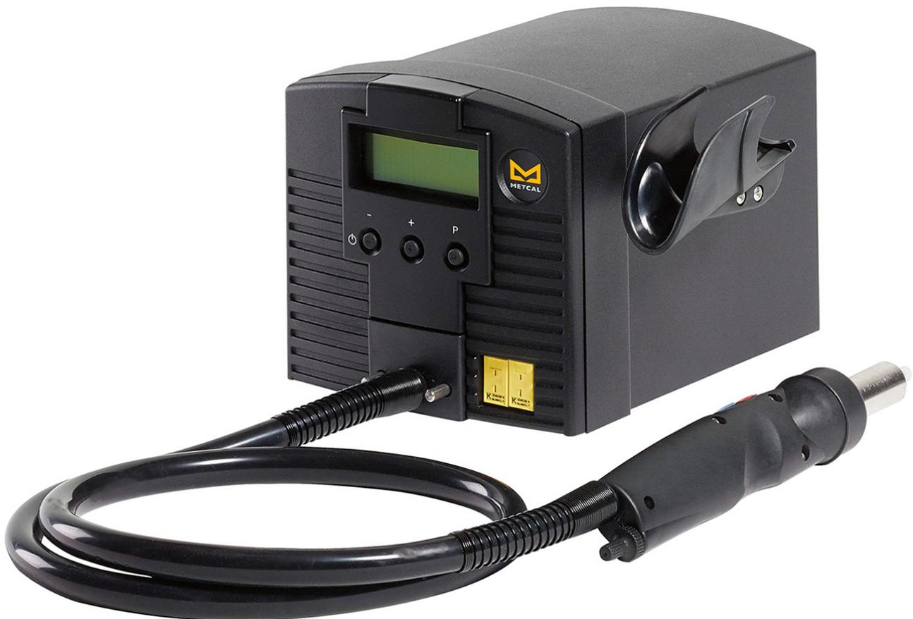
Das HCT-1000 System ist ein voll programmierbares, handgeführtes Rework-Gerät mit Konvektion, das SMT-Bauteile entfernen und platzieren kann. Es verfügt über eine digitale Steuerung, eine interne oder externe Thermoelement-Rückkopplungssteuerung, eine Programmspeicherung von bis zu 50 Profilen und eine integrierte Vakuumaufnahme für die Bestückung und Entnahme von Bauteilen.
