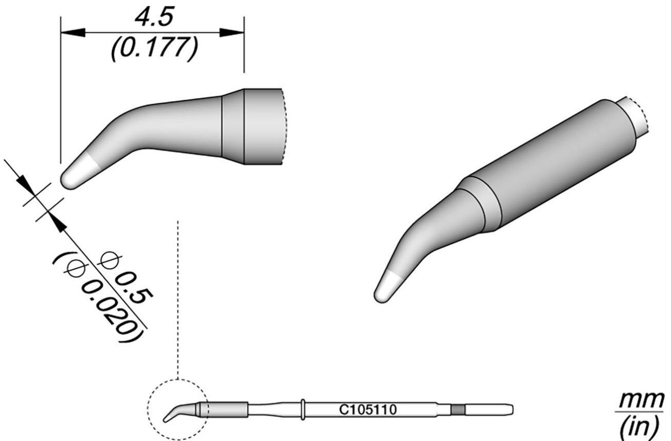
Die Lötspitzen der Serie C105 sind die kleinsten Spitzen der JBC-Serien und eignen sich hervorragend zum Löten und Reparieren sehr kleiner Bauteile. Diese sind kompatibel mit den NT105 und NP105 Nanohandstücken
