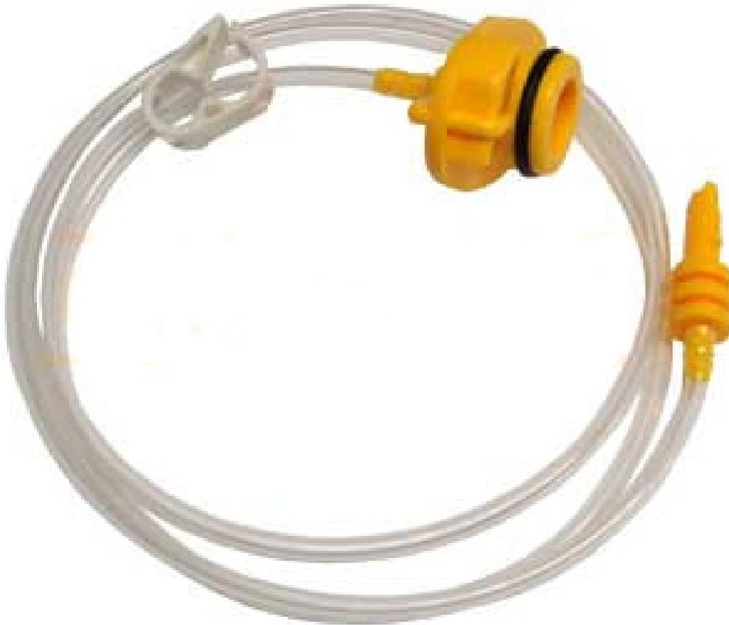
Kartuschenadapter sind das Bindeglied zwischen Controller und Kartusche. Verbindungsschläuche sind in einer Länge von 0,90 m und 1,80 m erhältlich. Das Set besteht aus Kartuschenadapter, O-Ring, Schlauch und Schnellverschlußkupplung. Die Kartuschenadapter sind aus Delrin gefertigt.
