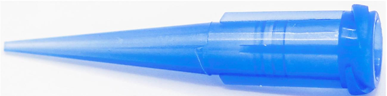
Diese Dosiernadeln bestehen aus Polyethylen mit UV-Licht-blockenden Additiven und besitzen einen Doppelhelix-Luer-Lock-Anschluss. Die konische Form verhindert das Verstopfen und verbessert den Fluß hochviskoser Medien. Erhältlich in Verpackungseinheiten von 50 Stück.
