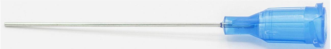
Die Nadeln der Serie TE bestehen aus einem silicon- und chloridfreien Polypropylen-Körper mit Doppelhelixgewinde und einer Edelstahlkanüle. Die Dosiernadeln sind gratfrei und haben elektrolytisch polierte Kanülen, die einen konstanten Materialfluß garantieren. Erhältlich in Verpackungseinheiten von 50 Stück.
