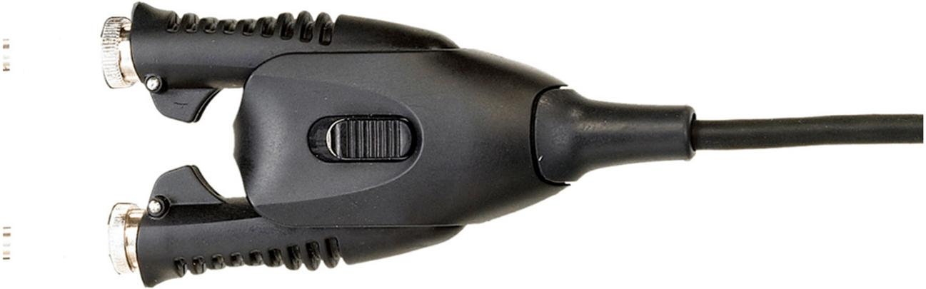
Präzisionspinzeten-Handstück für Systeme der Serien MFR-1100 und MFR-2200. Dieses Handstück ist ideal für die SMD-Entnahme von 0201-Widerständen bis zu 28 mm langen SOICs.
