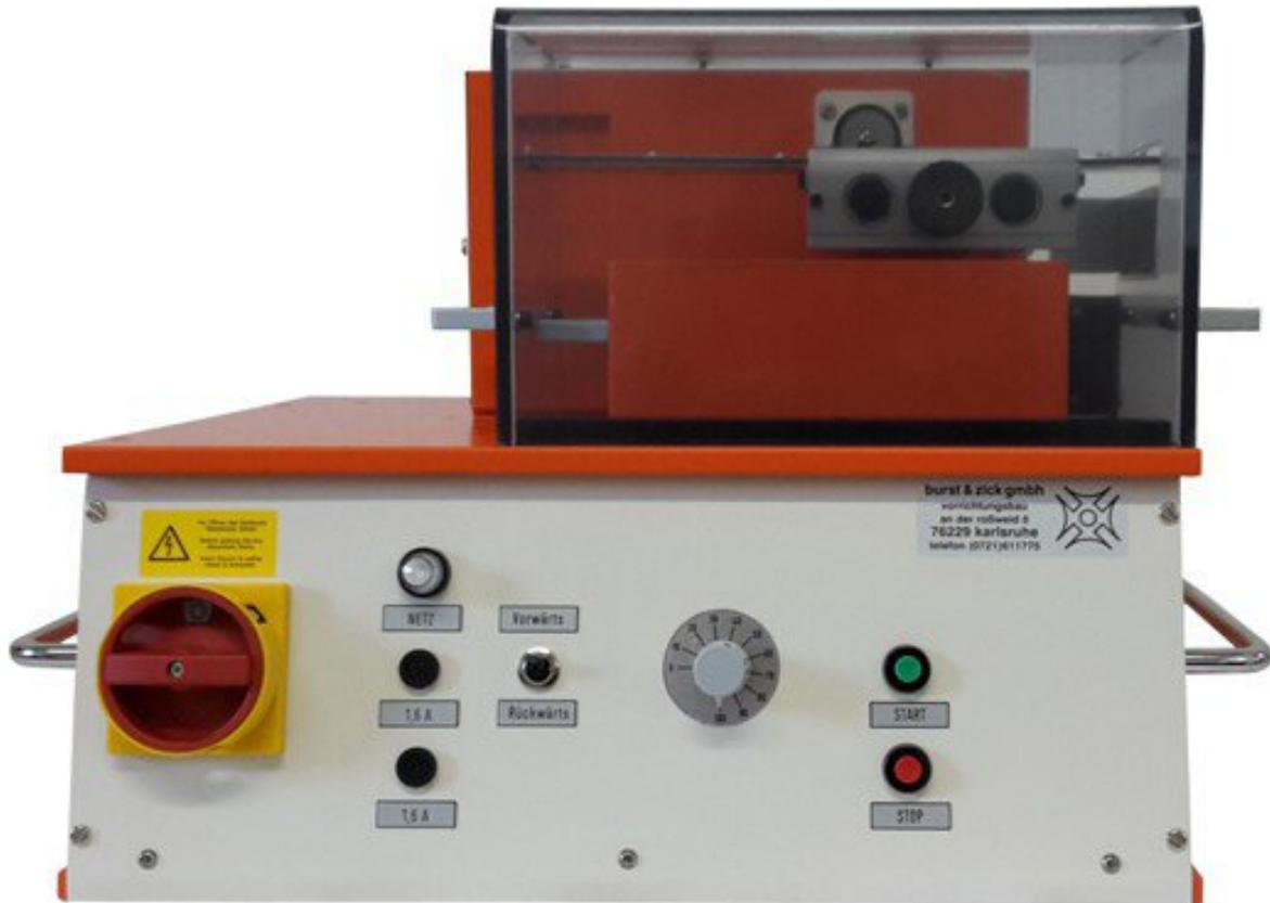
Schneidegerät für radiale Bauteile
