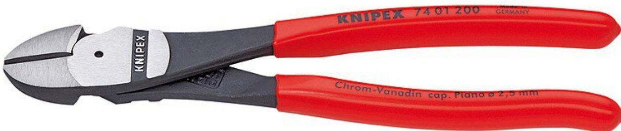
Für härteste, dauerhafte Beanspruchung. Hohe Schneidleistung bei geringem Kraftaufwand durch optimale Abstimmung von Schneidenwinkel und Übersetzungsverhältnis. Präzisionsschneiden zusätzlich induktiv gehärtet, (Schneidenhärte ca. 64 HRC) für alle Drahtsorten einschließlich Pianodraht. - Form: 0 - Schneidwerte mittelharter Draht (Durchmesser): Ø 3,4mm - Schneidwerte harter Draht (Durchmesser): Ø 2,5mm - Schneidwerte Pianodraht (Durchmesser): Ø 2,0mm
