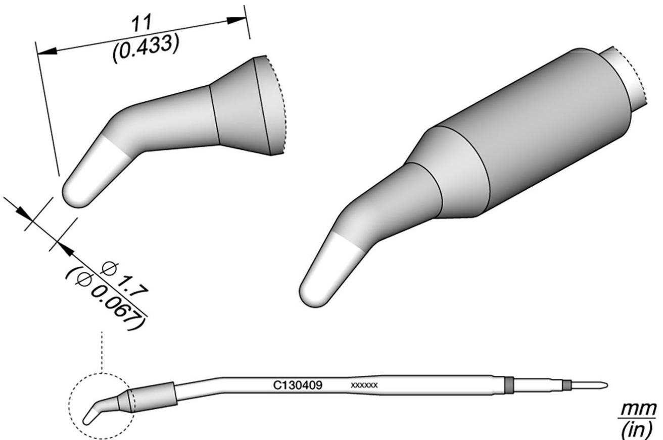
Die Löspitzenserie C130 sind für das Handstück AP130 geeignet und verfügen über gebogene Spitzen, die perfekt an die die Position des Zinndrahts angepasst sind. Die Spitzen können mit Hilfe der Verdrehsicherung am Handstück ausgerichtet werden.
