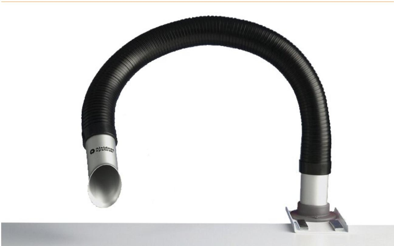
Das Alsident System 50 Flex ist für eine Luftmenge von 45 - 85 m<sup>3</sup>/h vorgesehen und hat einen Rohrdurchmesser von 50 mm. Speziell für den Bereich der Elektronikindustrie und in Labors ist das System Flex besonders gut geeignet.
