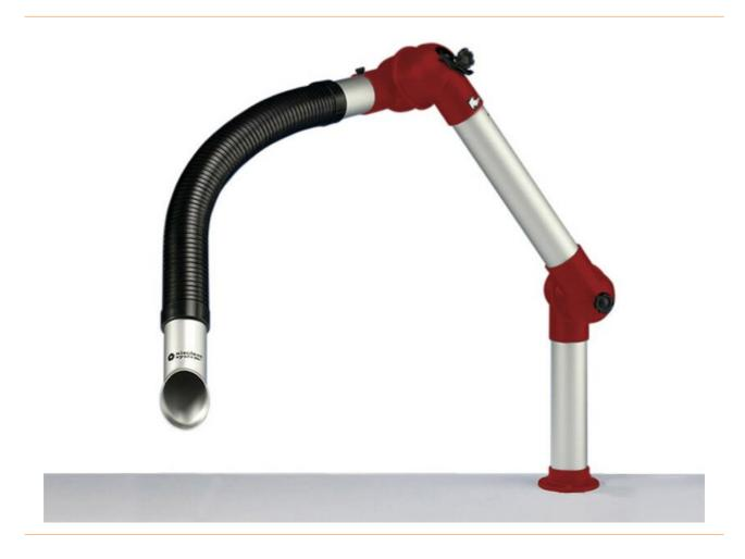
Das Alsident System 50 Flex ist für eine Lufmenge von 45 - 85 m3/h vorgesehen und hat einen Rohrdurchmesser von 50 mm. Speziell für den Bereich der Elektronikindustrie und in Labors ist das System Flex besonders gut geeignet.
