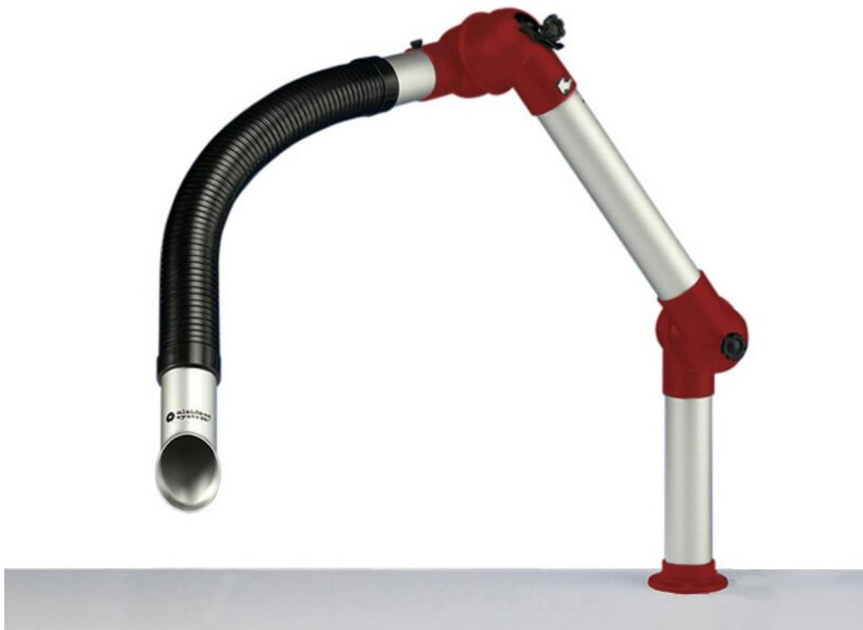
Das Alsident System 50 Flex ist für eine Lufmenge von 45 - 85 m<sup>3</sup>/h vorgesehen und hat einen Rohrdurchmesser von 50 mm. Speziell für den Bereich der Elektronikindustrie und in Labors ist das System Flex besonders gut geeignet.
