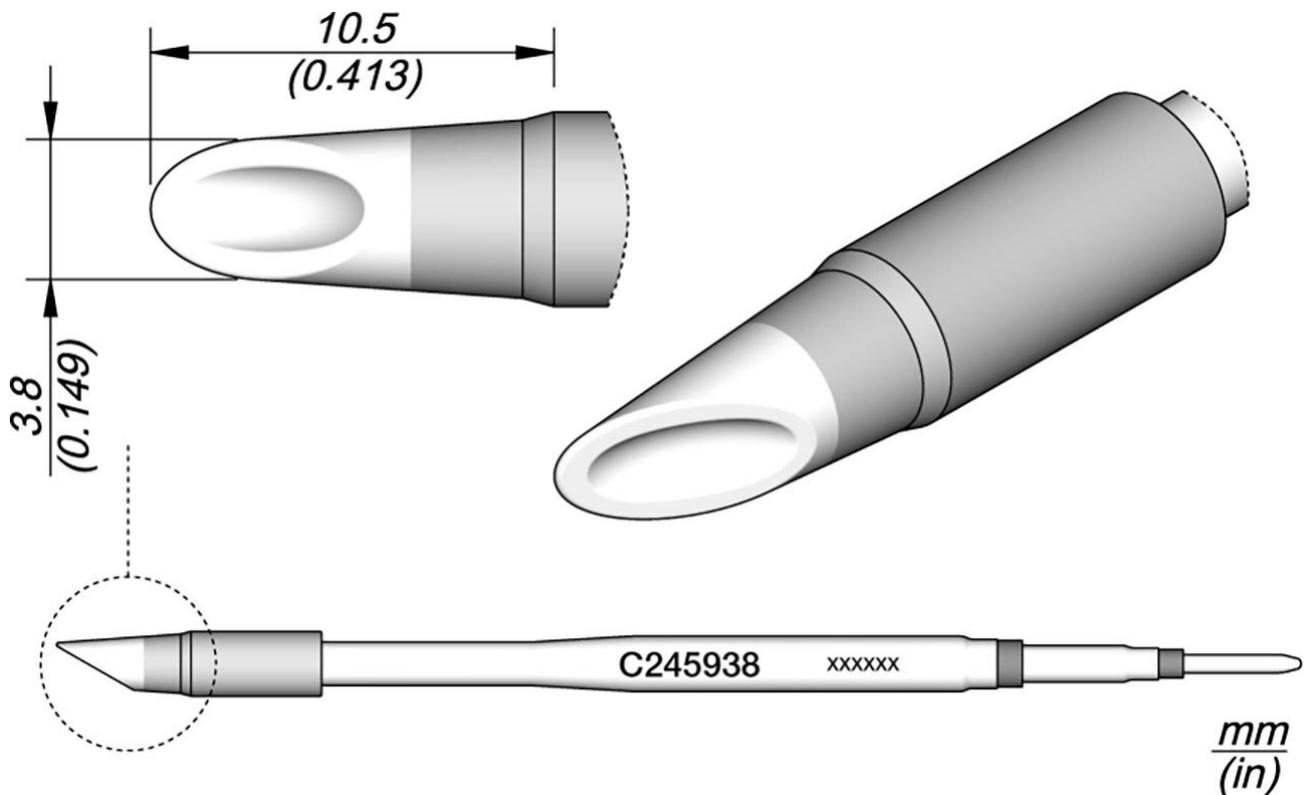
Die JBC C245938 Lötspitze mit löffelförmigem Profil (Mini Spoon) und einem Durchmesser von 3,8mm ist ein vielseitiges Werkzeug für professionelle Lötarbeiten. Sie gehört zur C245-Serie, die für ihre umfangreiche Auswahl an Formen und Größen bekannt ist und eine breite Palette an Anwendungen abdeckt. Mit einer Länge von 10,5mm eignet sich diese Lötspitze sowohl für die Bearbeitung von SMD-Bauteilen als auch für anspruchsvolle Lötaufgaben wie das Löten von Erdungsflächen.
