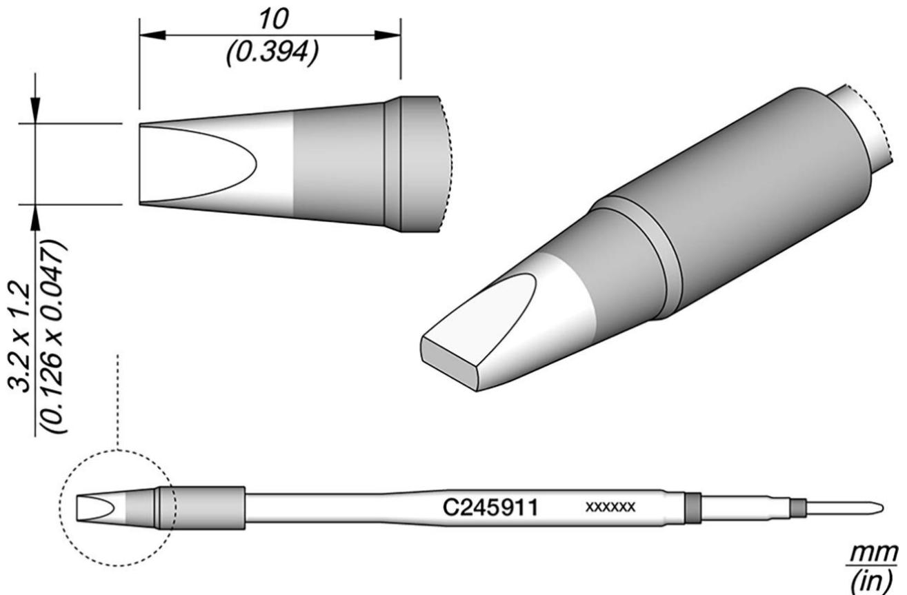
Die Lötspitze JBC C245911 ist eine hochwertige, meißelförmige Lötspitze mit den Maßen 3,2mm x 1,2mm, die speziell für den Einsatz mit den T245-LötKolben von JBC entwickelt wurde. Dank ihrer breiten, verzinneten Fläche und der optimierten Geometrie bietet sie eine hohe thermische Effizienz von bis zu 40%, was sie ideal für anspruchsvolle Lötaufgaben macht.
