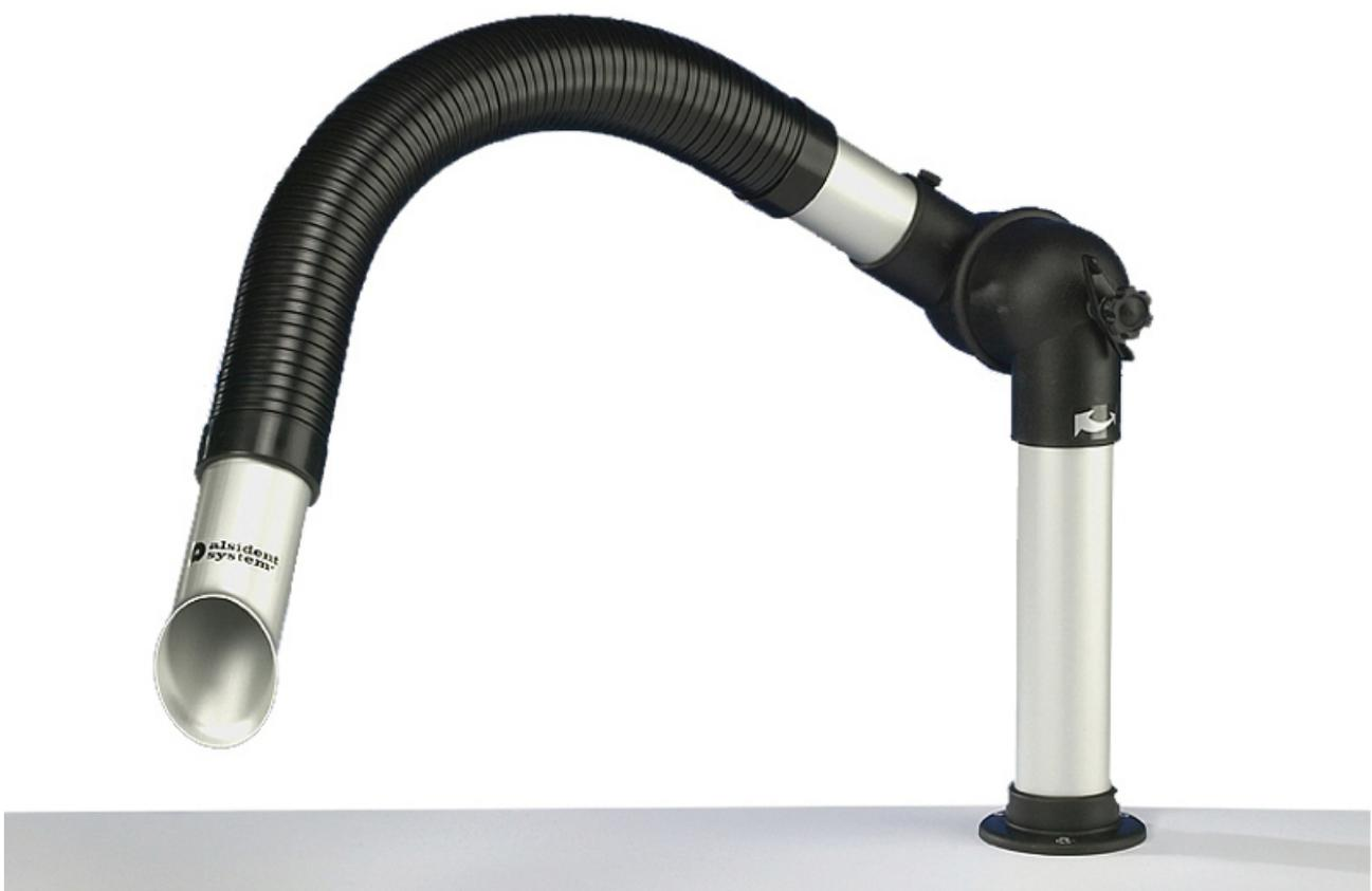
Das Alsident System 50 Flex ist für eine Luftmenge von 45 - 85 m<sup>3</sup>/h vorgesehen und hat einen Rohrdurchmesser von 50 mm. Speziell für den Bereich der Elektronikindustrie und in Labors ist das System Flex besonders gut geeignet. Der ESD Absaugarm entspricht natürlich den Anforderungen der DIN EN 61340-5-1.
