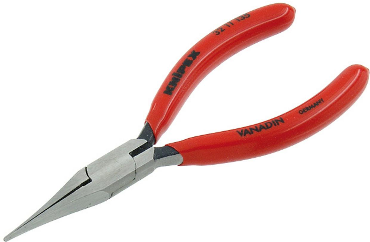
Zum Greifen von Bauteilen und Drähten mit kleinem Durchmesser sowie zum Biegen von Kontakt- und Relaisfedern. Polierte Greifflächen. Kanten sorgfältig entgratet. flache, spitze Backen. - Form: 1 - Backendicke (am Gelenk) (D): 7,0mm - Spitzenbreite (E): 1,0mm - Spitzendicke (F): 1,5mm - Backenlänge (B): 34,0mm - Kopfbreite (A): 12,5mm
