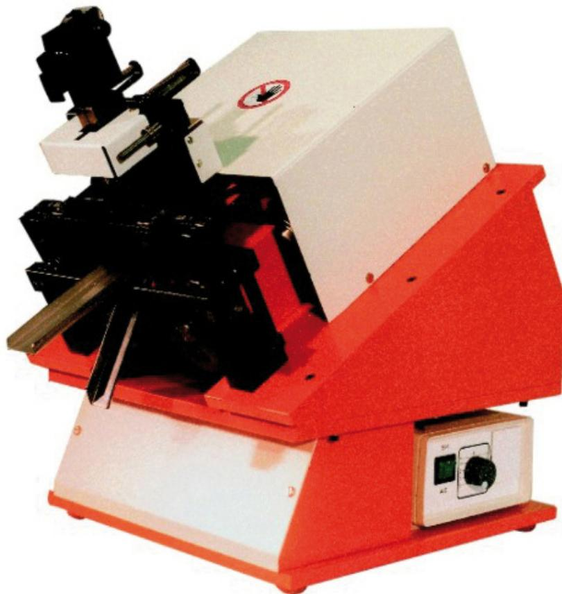
Schneide- / Präge- + Biegegerät für radiale Bauteile
