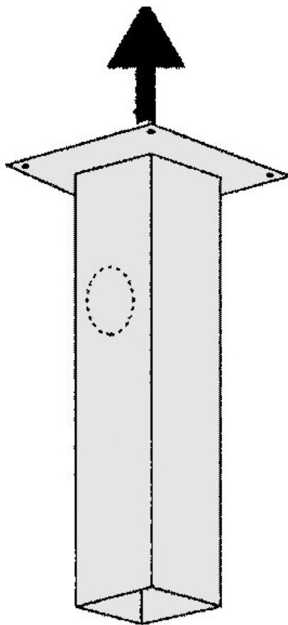
Mit den Sockelkästen von Alsident ist die Montage der Absaugarme für Deckenmontage sehr einfach zu bewerkstelligen. Diese sind aus Stahl hergestellt und auf allen Flächen mit einer TGIC Pulverlackierung versehen.
