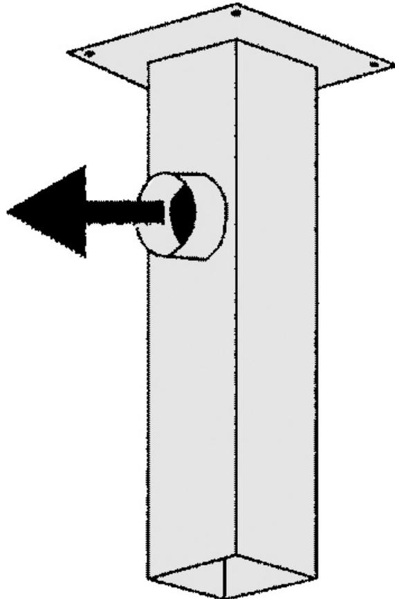
Mit den Sockelkästen von Alsident ist die Montage der Absaugarme für Deckenmontage sehr einfach zu bewerkstelligen. Diese sind aus Stahl hergestellt und auf allen Flächen mit einer TGIC Pulverlackierung versehen.
