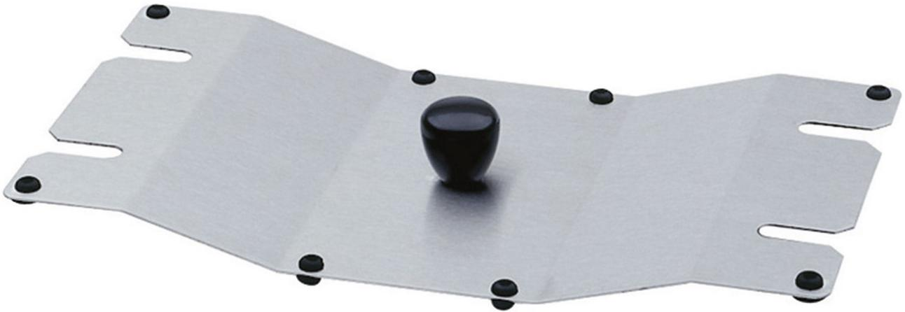
Ein passender Deckel aus Edelstahl für ein Ultraschallbad schützt die Badflüssigkeit vor Verunreinigung von außen und verhindert eine Geruchsbelästigung durch die zugesetzten Reinigungs- bzw. Desinfektionspräparate. Darüber hinaus wird die möglicherweise als störend empfundene Geräuschabgabe beim Betrieb des Ultraschallreinigers verringert. Die Deckel sind so konstruiert, dass entstehendes Kondenswasser in die Wanne zurück geleitet wird.
